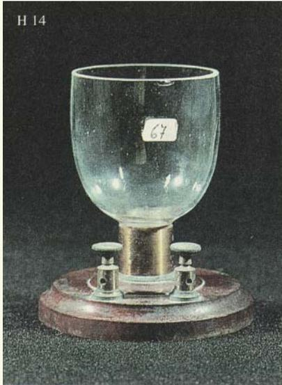
Lo strumento è composto da un bicchiere di vetro nel cui fondo sono evidenti i collegamenti agli elettrodi che compaiono sulla base in legno dello stesso).
