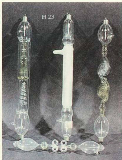
Elaborati tubi di vetro costruiti sull'esempio di quelli di Geissler, utilizzati per studiare gli effetti delle scariche elettriche in gas a basse pressioni.
