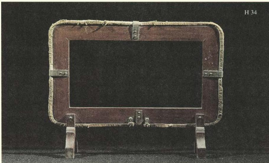
Lo strumento è una bobina rettangolare da utilizzare in esperienze di elettromagnetismo. Molti possono essere gli usi di una tale bobina. Le dimensioni inoltre ne fanno un apparecchio dimostrativo di facile uso e dai suggestivi risultati per esperienze sulla visualizzazione delle linee di forza di un campo magnetico o su fenomeni legati alle correnti indotte.
