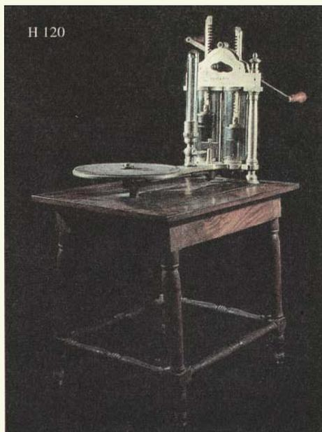
Lo strumento è costituito da due cilindri, i cui stantuffi sono collegati tra loro per mezzo di un rocchetto e di due aste dentate, e da una piattaforma collegata agli stantuffi attraverso un foro centrale.
